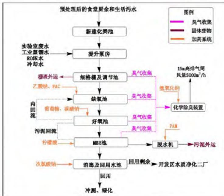
图 3.5 污水处理工艺流程示意图
